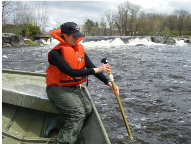
Photo 7 : Mesure de la vitesse du courant
